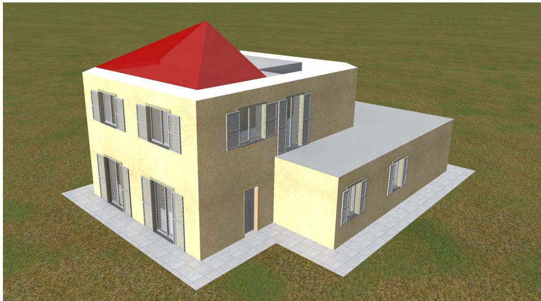
Figura D.4_Porzione di copertura a falda disperdente
